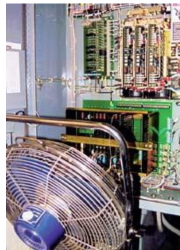
Här är risk för elstöt när dörren öppnats för att låta en fläkt blåsa smutsig luft på kretskortet.
