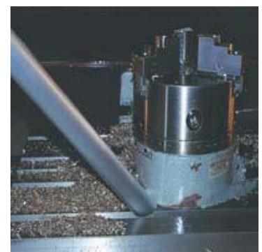
Chip Vac suger upp slitande spån av rostfritt stål från en CNC-fräs.
