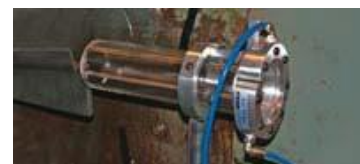
En Standard Air Wipe blåser kylvätska från detaljen och tillbaka in i slipmaskinen..
