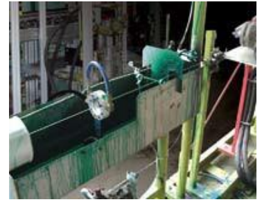
En 2431 1" (25mm) Standard Air Wipe blåser bort överskottsmaterial från en kabel till en dopptank.
