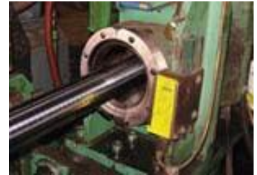
En 2404 4" (102mm) Super Air Wipe rengör en stålstång efter bearbetning.
