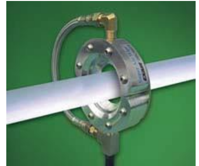
En 2402 2" (51mm) Super Air Wipe kyler PVC-rör efter extrudering.
