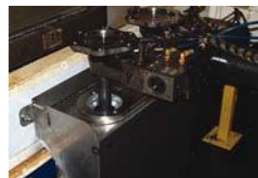
En drivaxel lyfts genom en Super Air Wipe för att blåsa bort spånar efter bearbetning.
